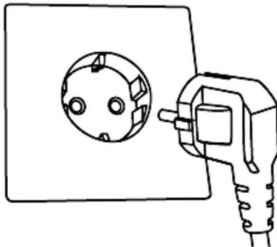
Sie benötigen eine dem Netzstecker entsprechende ordnungsgemäß geerdete und ausschließlich dem Gerät zugewiesene Sicherheitssteckdose (250 V / 10A).
